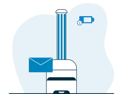
06. UVS Robot invia il rapporto di sanificazione e torna alla stazione di ricarica
